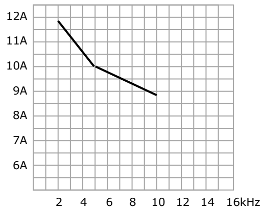
Low Duty Ub-03=01 I_{\text{nenn}}=11,9\text{A} (14,2A für 60s)
